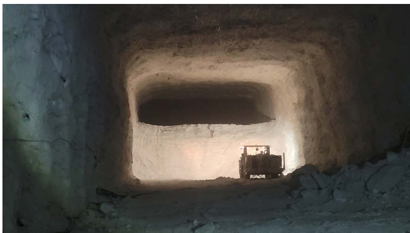
Ryc. 5. Komora eksploatacyjna białej soli kamiennej na poziomie 780 kopalni
